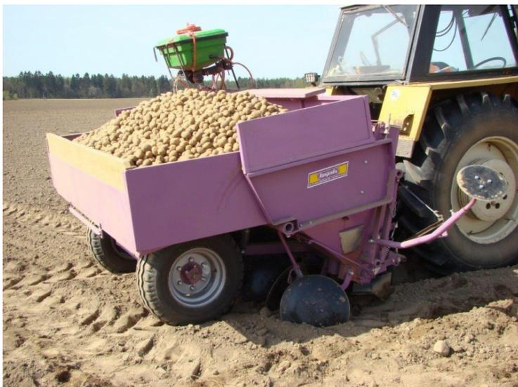
Автоматическая навесная четырехрядная сажалка POLA 4 разработана для посадки проросшего картофеля с междурядьем 75 или 90 см. Используется с тракторами класса 1,4, производительность 1,5 га/час. Сажалка POLA 4H оснащена в стандарте гидравлически поднимаемым бункером.
